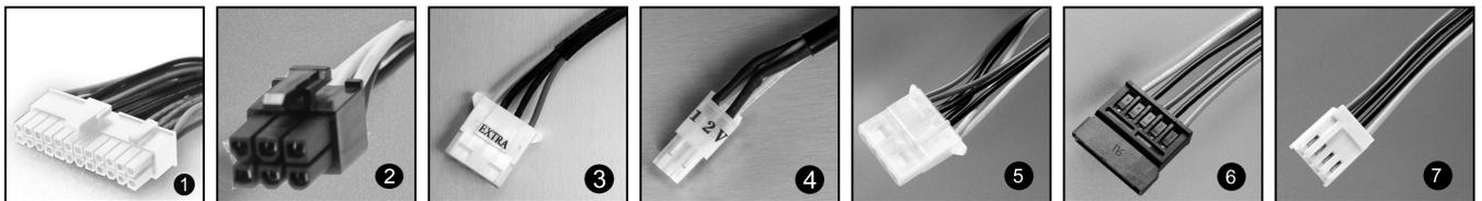
24 ピンのメインパワーコネクタ(図 1)をマザーボードの接続コネクタに差し込みます。
